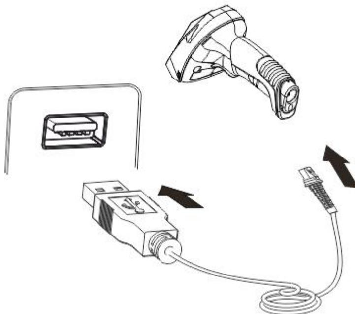
1. 将 USB 数据线的设备接口端（RJ45 接口）与 NVH300 相连；
