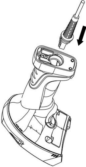
2. 将数据线卡槽处的螺丝逆时针旋开；
