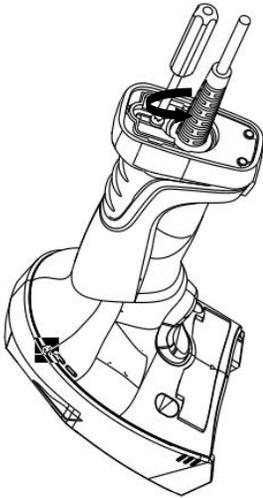
3. 将线缆压片往箭头所示方向移动；
