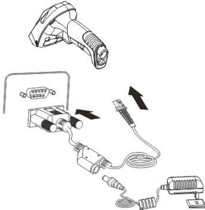
1. 将 RS-232 数据线的设备接口端（RJ 45 接口）与 NVH300 相连；
