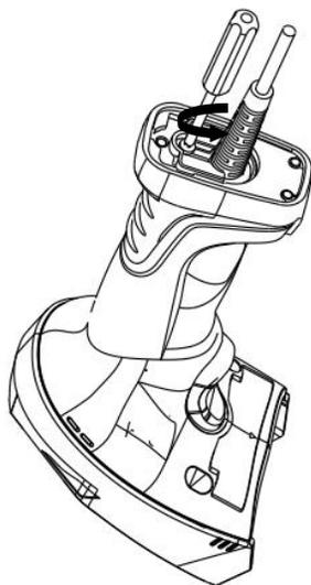
2. 将线缆压片往箭头所示方向移动;
